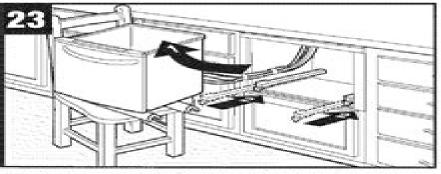
Set drawer on chair using protective covering. Push rails in./Coloque el compartimiento sobre una sitta, utilizando material protector. Empuje hacia advetro los rieles./Flacez le tiroir sur une chaise recouverte d'une couverture protectrice. Poussez les glissières à l'intérieur.
