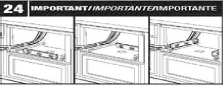
Check level left to right and front to back./Compruebe à révelación de Erquierda a derecha y de delante hacia atrás./Assurez-vous que l'appareil est de niveau.
