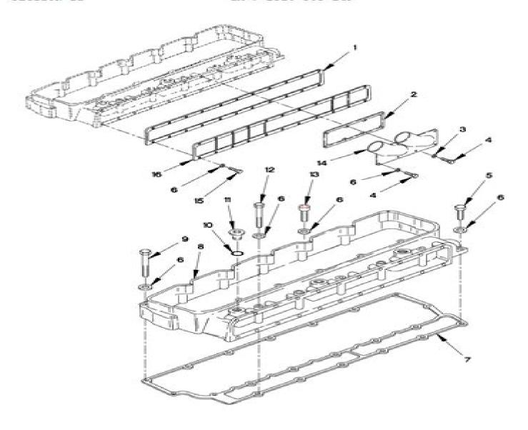
FIGURE 23. INLET MANIFOLD, GASKET AND COVER
