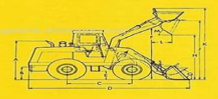
Abmessungen und technische Daten für 0,9 m² Schaufel und 13,00 x 24, 8 PR-Reifen. Anwendbare techn. Daten und Abmessungen entsprechen SAE Standard J 732 C (1969).
