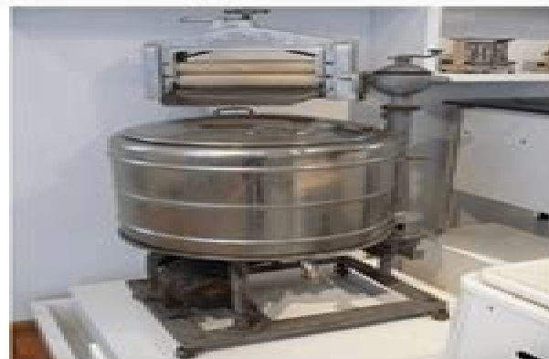
Autre machine datant de 1930. Elle est dotée d'un moteur électrique et d'une cuve métallique, mais reste fonctionnellement équivalente au modèle précédent.
