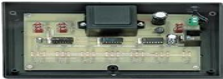
Figure 599 : Photo du circuit imprimé vu du côté des composants. Les LED devront être montées sur le côté opposé.
