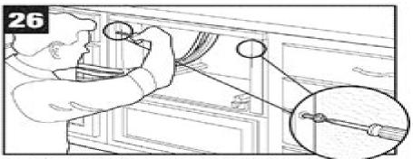
Attach to cabinet brackets with screws provided./Instale los seportes del gabinete con los tornillos suministrados./Fixez les supports de l'armoire avec les vis foamies.
