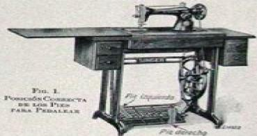
La postura más cómoda y eficaz para mover el pedal es poniendo la parte redonda de la planta del pie izquierdo sobre la esquina superior izquierda del pedal y el talón del pie derecho sobre la esquina inferior de la derecha (Fig. 1). Con los pies en esta posición se necesita mucho menos esfuerzo para mover el pedal que si se colocan en cualquiera otra posición,
