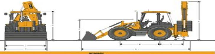
Koparko – ładowarki JCE mają jednoczęściową, wzmocnioną namę główną przepnaczoną do pracy pod wysokim obciążeniem, układ napędowy oparty o typowe podzespoły I w pełni zamkniętą komorę silnika. Wszystkie zbiorniki płynów i komory podzespołów są zamykane przy pomocy kluczyka stacyjki.
