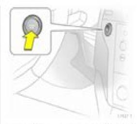
Premere il pulsante Start/Stop. Viene inserita l'accensione e vengono disattivati il dispositivo elettronico di bloccaggio del motore e il bloccasterzo.
